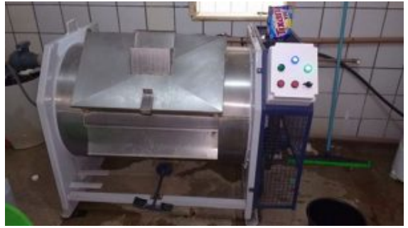
Máquina de Lavar Industrial 40 quilos em água quente em pleno funcionamento no Hospital Municipal de Novo Progresso.
